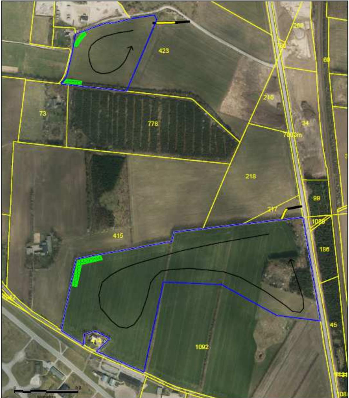
Kort fra indvindingsansøgningen, som foruden matrikler (gul) og de ansøgte arealer (blå) også viser grave-retning (sorte pile), støjvolde (grøn) og ansøgte adgangsveje (gul og sort streg).
