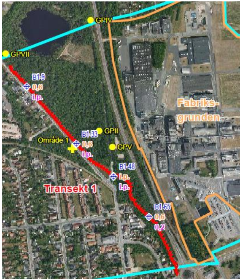
Figur 8: Undersøgelser af poreluft og øvre grundvand nedstrøms for fabriksgrunden (fra COWI A/S, 2011). Røde trekanter: Poreluftmålinger. Blå skrift: Boringsnumre. Orange skrift: Sum af sulfonamider og barbiturater i grundvand ( \mu\text{g/L} ). Pink skrift: Sum af chlorerede opløsningsmidler ( \mu\text{g/L} ). Bemærk: GPII er placeret for langt mod nord og GPV er placeret for langt mod vest, da den reelt står umiddelbart øst for Simmelbrovej. Se figur 1.
