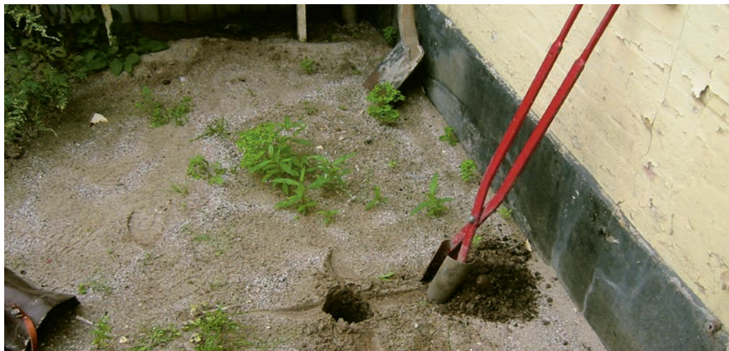
Figur 5 Udtagning af jord til overfladeprøve vha. spadestik
