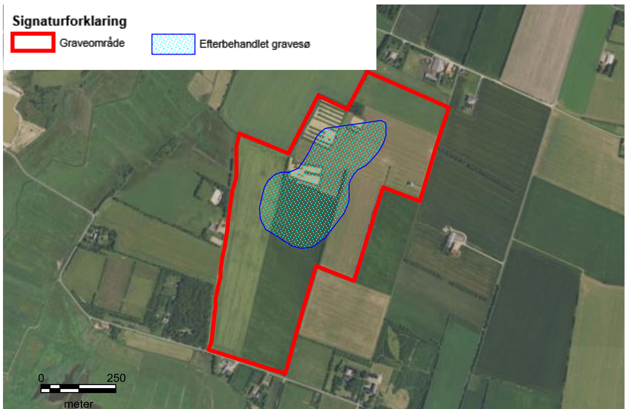
Figur 10 - viser placeringen af den ændrede efterbehandlede gravesø. Søens placering kan afhænge af undergrundens sammensætning.
