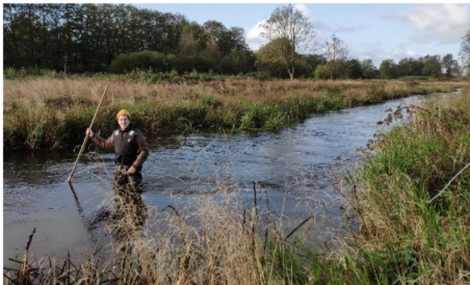
Figur 3: Indsætning af spyd i å-bunden med fastmonteret slange til vandprøvetagning.
