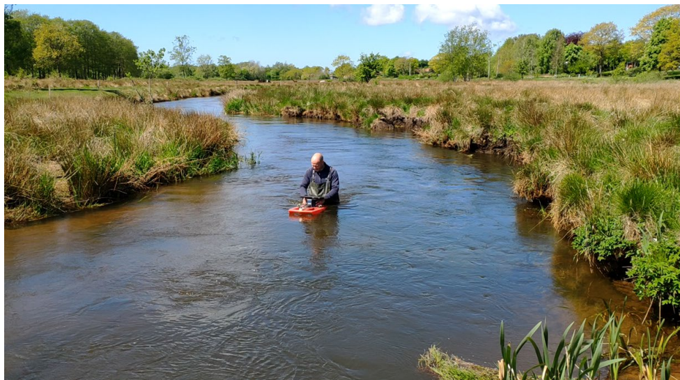
Figur 2: Vandføringsmåling med ADCP-båd udført af Orbicon/WSP.
