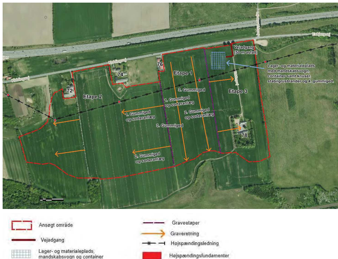
Figur 2.1. Det ansøgte område med de 3 graveetaper samt lokalisering af adgangsvej i nord til Koldingvej med videre forbindelse mod vest til Esbjergmotorvejen, som ses nord herfor.
