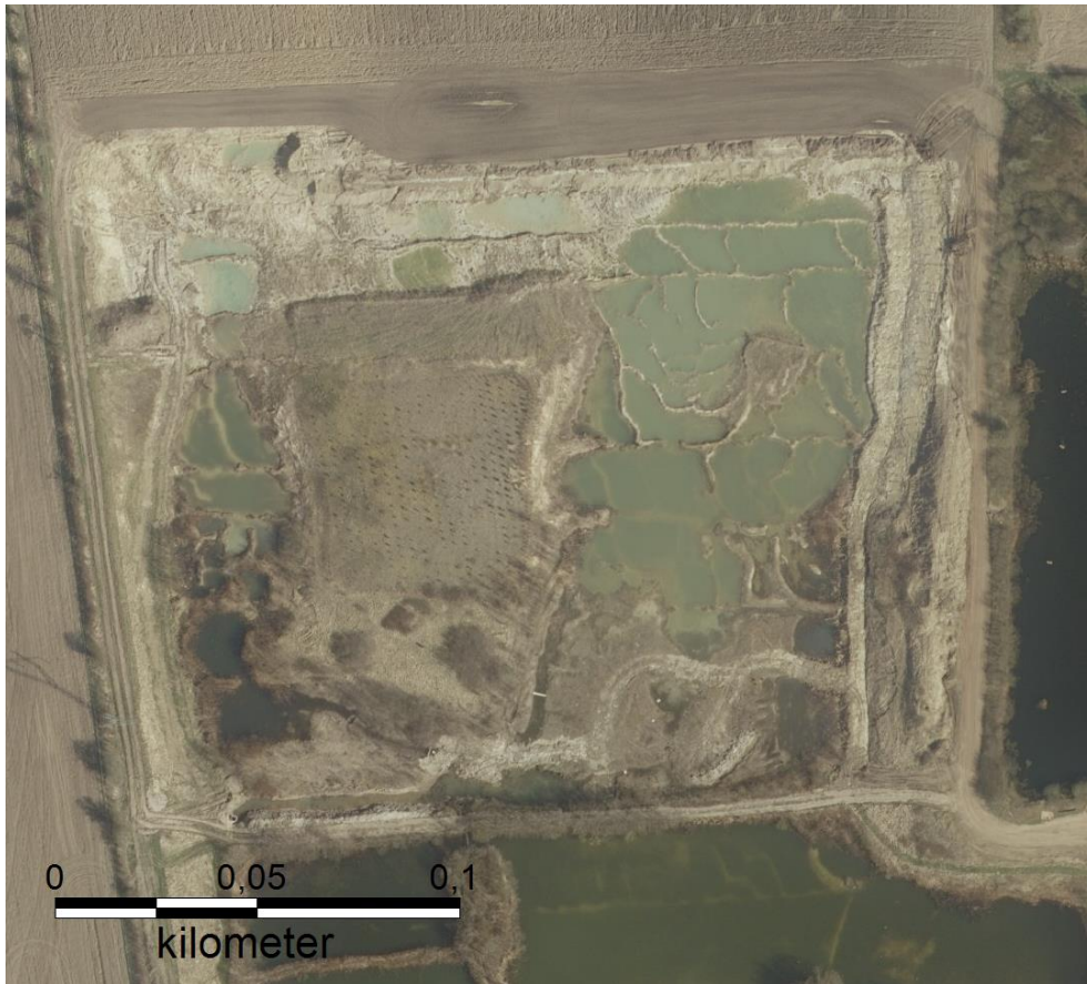
Figur 1. Området syd for Præstevænget Nord, luftfoto 2018. Ved gravning i terrasser håndteres det overfladevand, som samler sig i graven, og som ender med at blive til søer i de efterbehandlede grave.
