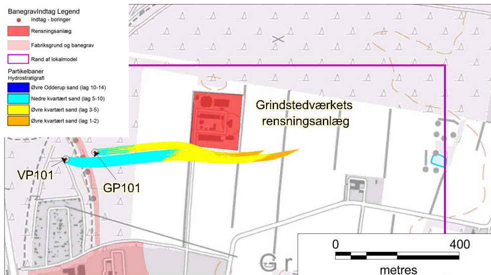
Figur 2: Partikelbaner fra de øverste indtag i VP101 og GP101. partikelbanerne er mod grundvandsstrømmen og den orange farve angiver hvor nedsivningen i modellen forekommer.
