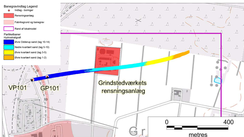
Figur 3: Partikelbaner fra de nederste indtag i VP101 og GP101. partikelbanerne er mod grundvandsstrømmen og den orange farve angiver hvor nedsivningen i modellen forekommer.
