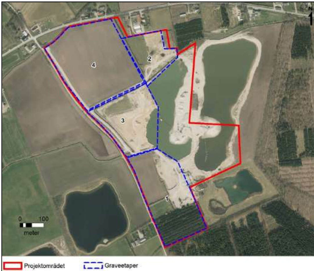
Bilag 1c: Graveplan for projektområdet (rød afgrænsning) med afgrænsning af graveetape 1-4 (stiplet blå afgrænsning). Fra Miljøkonsekvensrapporten, maj 2020.
