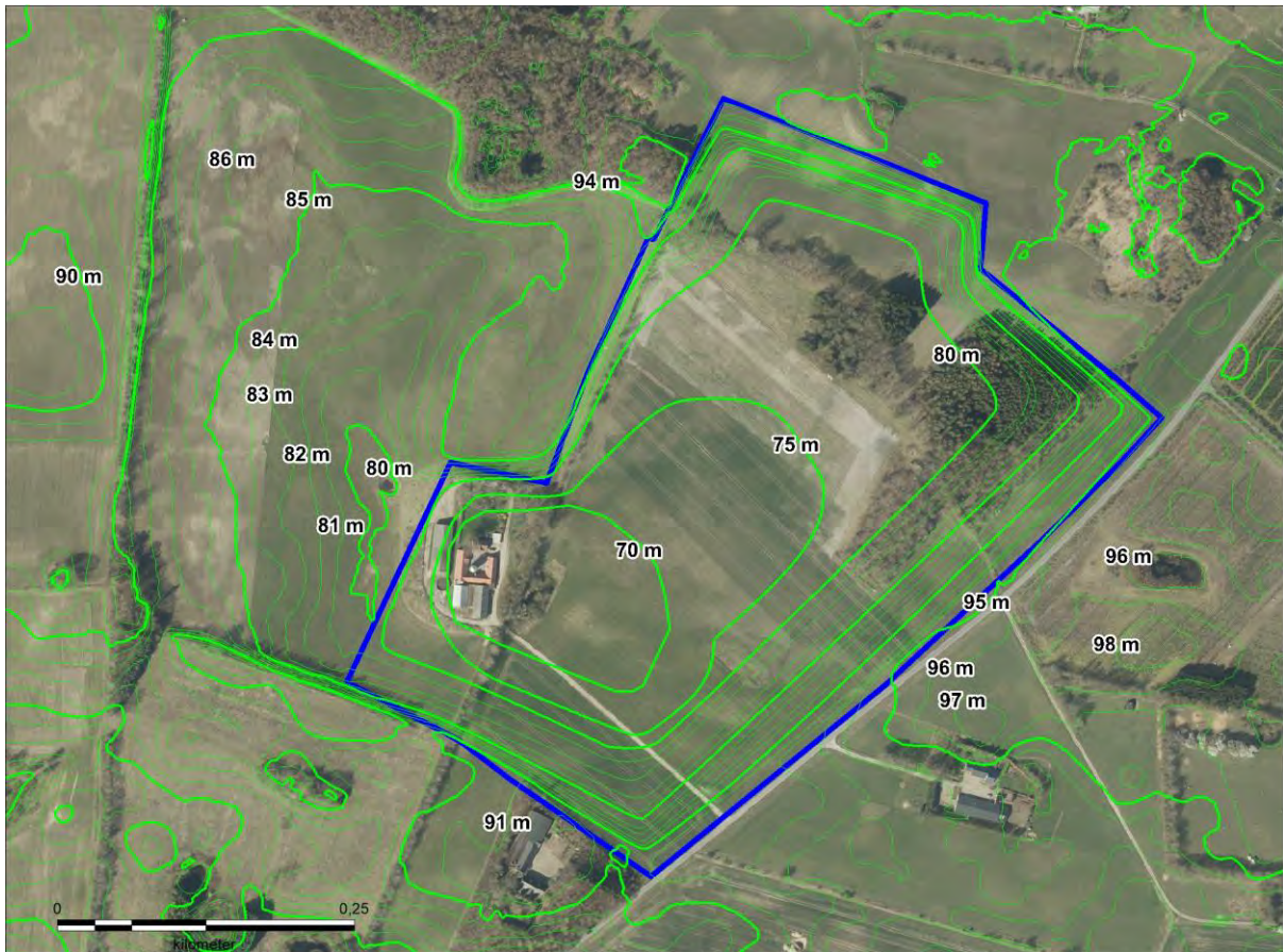
Figur 3. Det ansøgte område med blå stregfarve. De grønne konturlinjer viser et overordnet forslag til, hvorledes det efterbehandlede terræn vil udforme sig efter endt efterbehandling.
