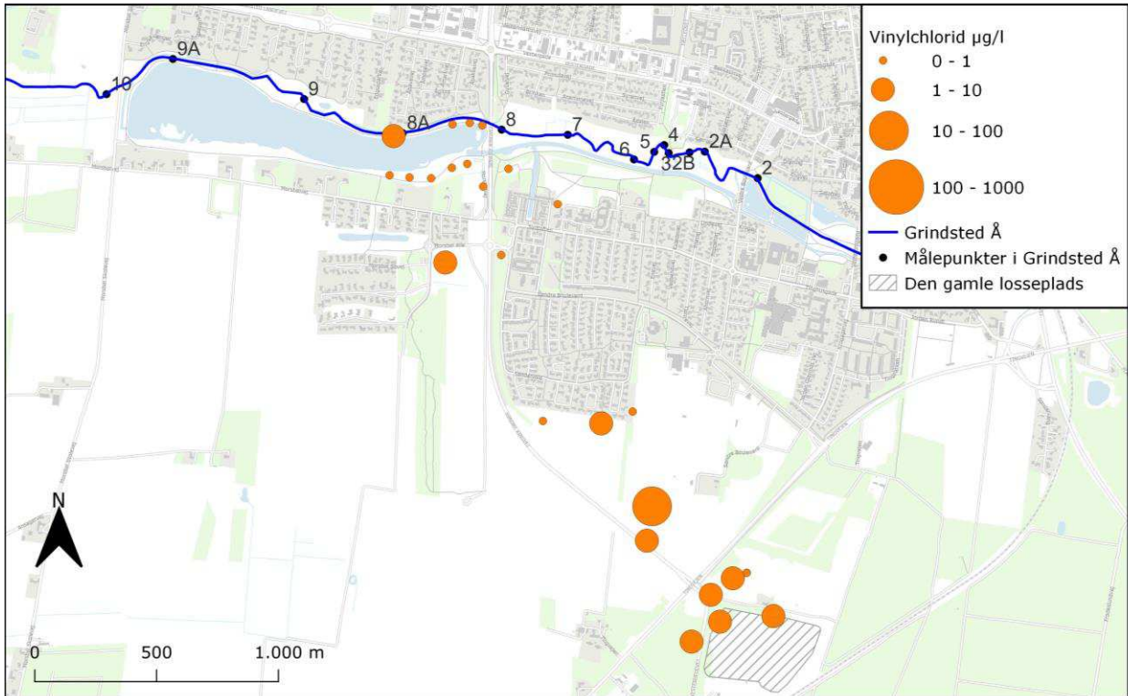
Figur 4 Maksimale koncentrationer af vinylchlorid, der er påvist i borer i forureningsfanen fra lossepladsen til Grindsted Å.
