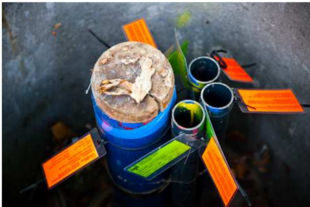
Figur 1.2. Boringen med DGU nr. 114.1424 er forsynet med 5 filtre. Dette er et godt eksempel på, hvorledes boringer i området kan være udbygget. Trods skiltning er der gode muligheder for forveksling af filtre.
