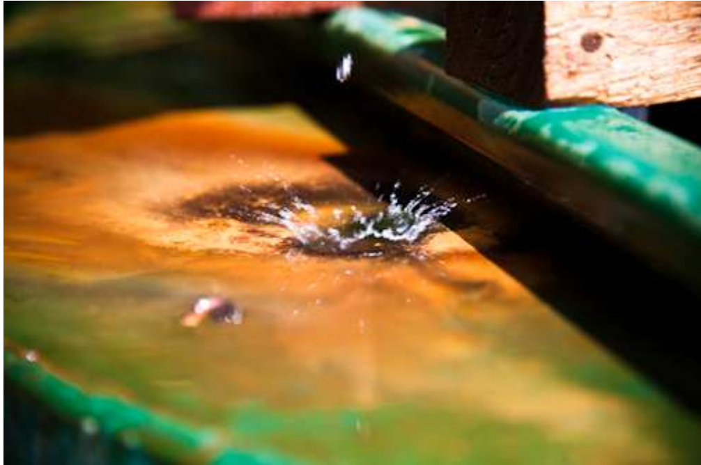
Figur 5.2. Lille utæthed ved afgangen fra pumpeboringen. Analyseresultaterne viser, at der tale om uforurenet grundvand.
